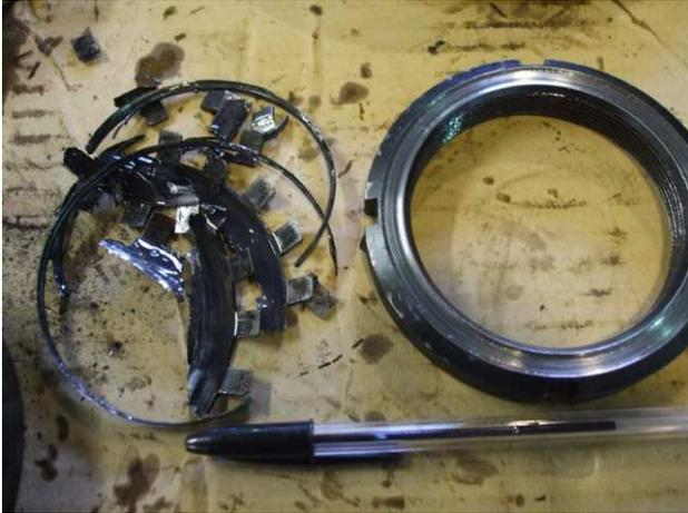
*Sull'albero veloce è stato rilevato un problema, la rosetta che fermava la ghiera di serraggio del cuscinetto risultava completamente frantumata. La ghiera di conseguenza era rigata così come i rulli del cuscinetto; una volta rimosso questo, si notava anche che aveva girato sulla sede e la porzione di albero risultava danneggiata. Questa era probabilmente la causa della presenza di particolato metallico nel lubrificante.*
