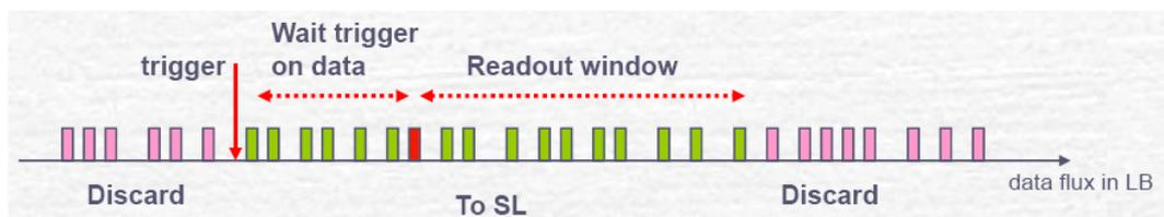
Figura 2.31: Schema dell’algoritmo B. La finestra di lettura viene aperta dopo aver “visto” un hit corrispondente al canale in cui è inviato il trigger; la durata temporale della finestra è preimpostata
